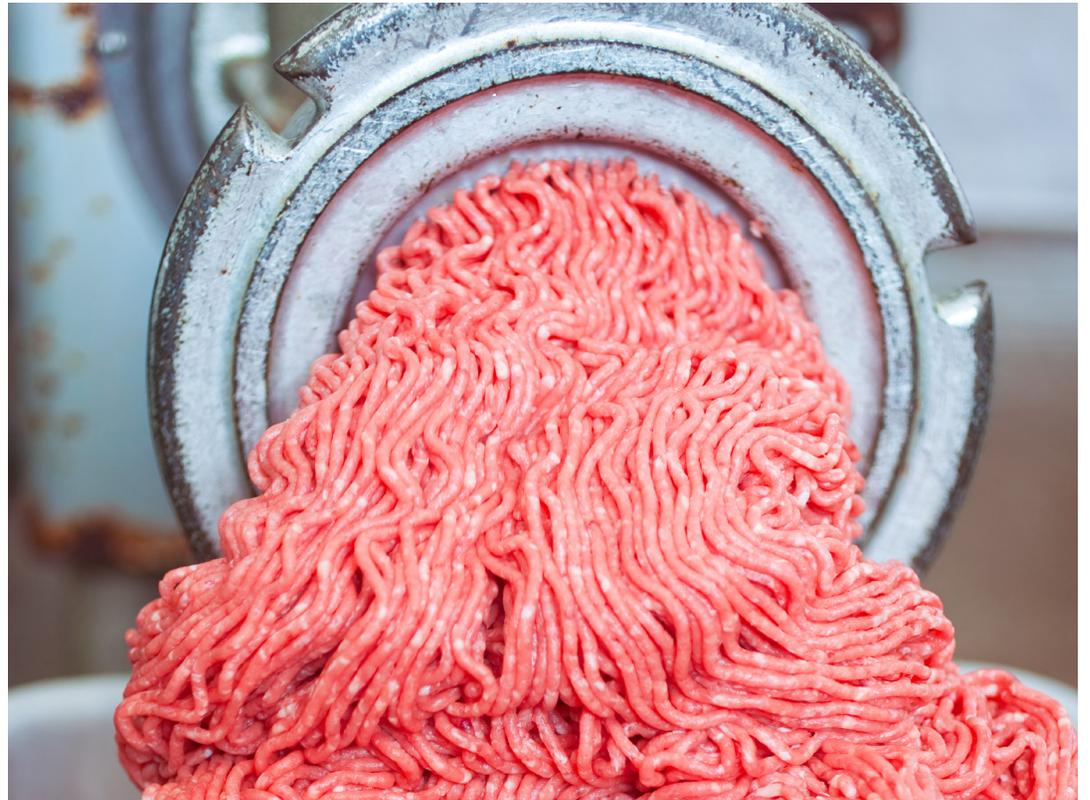
L'azote liquide peut être utilisé pour aider à maintenir la température froide de la viande grâce à une injection contrôlée directement dans le produit pendant le mélange ou le broyage. L'injection d'azote est réglée pour fournir le froid nécessaire en tout temps, en ajustant la consommation d'azote liquide aux exigences du processus.
